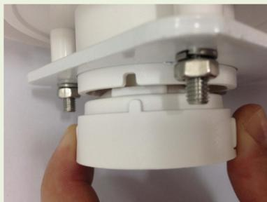
2. 将电池装入传感器，然后再将传感器及底座装回到外壳里，注意底座凸出部位要对准外壳凹的部位（下图红色框框）。
